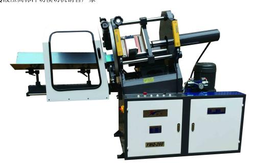
然后作空运转试车,检查调节好液压系统压力与流量,建议压力表调节到6kg为佳,不可调的太高,以免影响油泵使用寿命。如良好便可以开始操作。 调节压力时先启动油泵,松开压力表阀门及调节压力阀门,再按住后退
