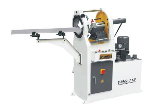
本机附带一块对刀模块,先将要切的坯料拿一张用胶水粘贴在对刀模块的下角,要求对边整齐,再将模切刀对准图案,用压板螺丝紧固拿到装料架上,本机装刀盘上有四个刀架压板,将刀架压板精确地对准刀模紧固妥当,再松开模切刀上的压板螺丝拿掉对刀模块。一切调节妥当,便可开始送料工作。建议先用点动控制,如推料及出料都顺利,便可自动控制,机器前上方手轮是微调装置,可调节纸品周边误差。
